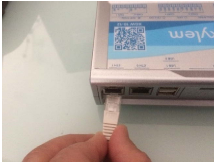
Abb. 3.6 RJ45-Schnittstelle (ETH 1), Verbindung zu einem bestehenden Netzwerk über ein Kabel
